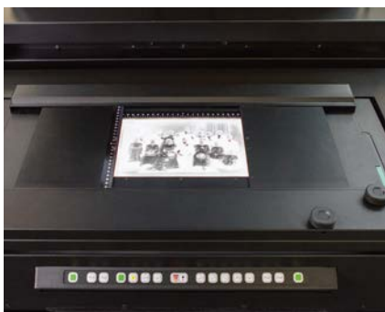
Vorlagenhalter für Glasnegative und andere Durchlichtvorlagen
