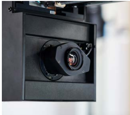
Kamerasystem auf Basis eines CMOS-Sensors
