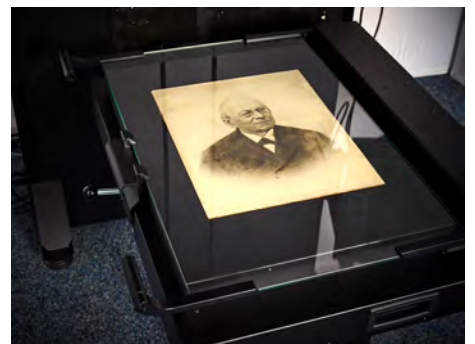
Fotostisch mit Glasplatte und Softpad für besonders empfindliche Vorlagen
